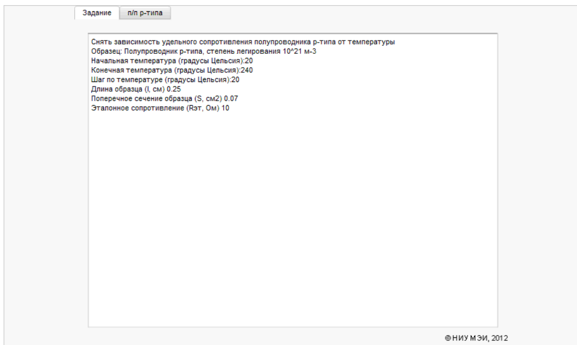
Рис. 5. Вкладка «Задание» виртуальной лабораторной работы «Электропроводность полупроводниковых материалов»
